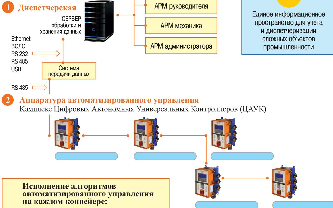
Исполнение алгоритмов автоматизированного управления на каждом конвейере:
